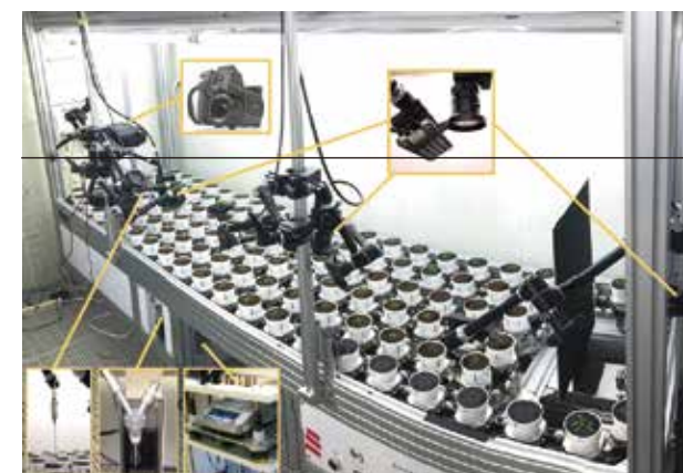
図2. 植物自動育成観察システムRIPPS Figure.2 RIPPS (RIKEN Phenotyping System)
