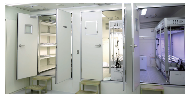
図2. 植物自動育成観察システムRIPPS Figure.2 RIPPS (RIKEN Phenotyping System)
